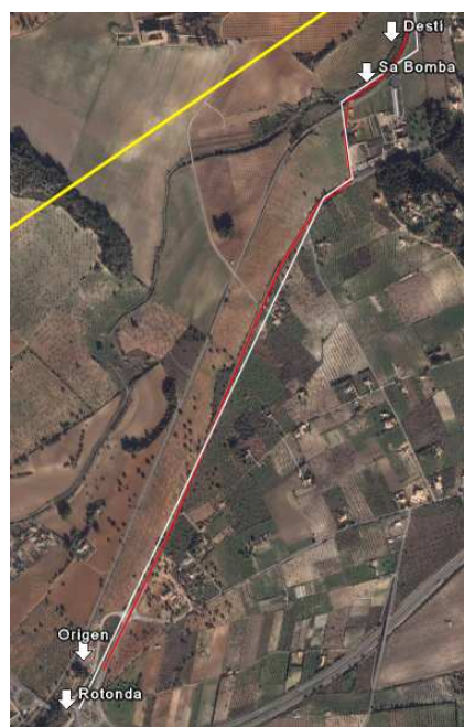
Figura 7. Primer tram de l'accés per la rotonda. Groc eix principal, vermell traçat real de la carretera, blanc eix teòric.
